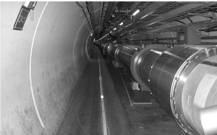
23. Blick in den Tunnel des LHC mit den Beschleunigermagneten und den darin befindlichen Strahlrohren
